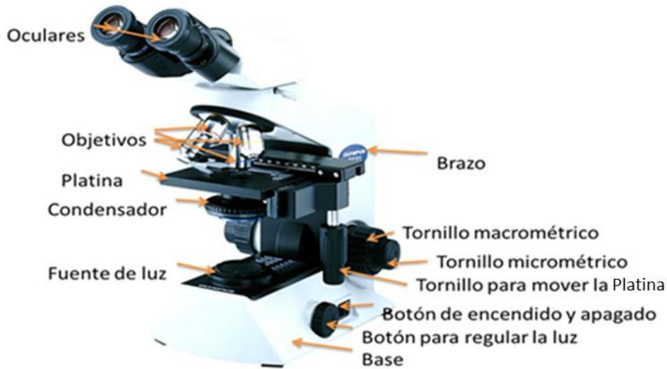
Figura 1. Microscopio compuesto
